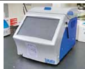
写真2 系統診断用の機器
