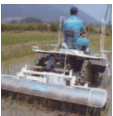
高精度水田用除草機による機械除草作業
